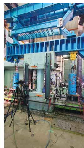
RC柱におけるひび割れ進展を評価するためのデジタル画像相関法 (DIC) の適用 (共英製鋼・長谷工コーポレーション・東京科学大学の共同研究)
