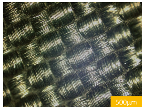
ウェアラブルセンサ用プラチナ／シルクハイブリッド材料
