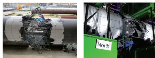
(a) 軸力比 0.2 (b) 軸力比 0.43 写真-2 PHC杭の曲げ破壊
