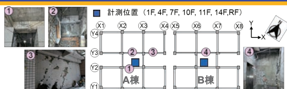
図1 対象建物の1階平面性状と被害状況、計測位置
