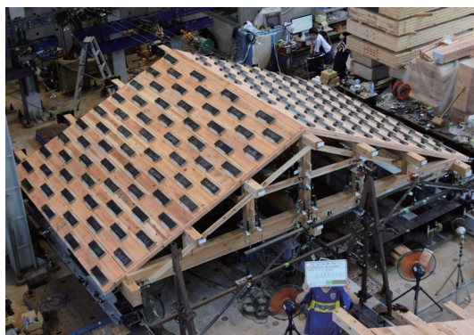
伝統的工法による小屋ばり組の 実大水平加力実験
