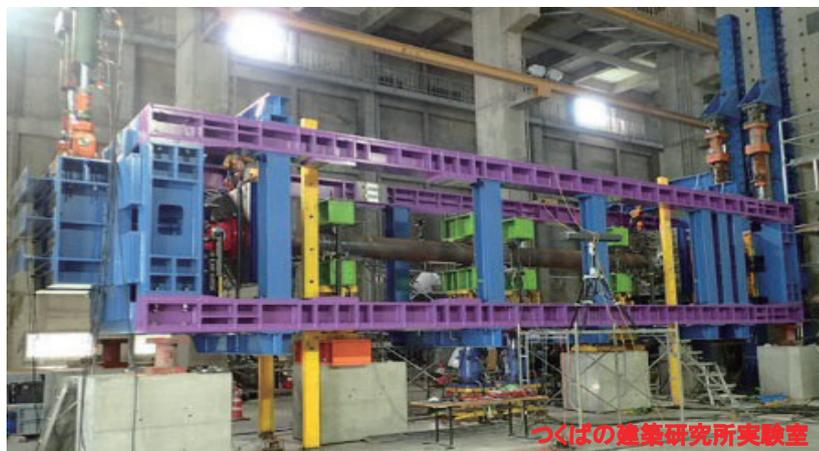
鋼管やコンクリートを使った杭の耐震性能評価
