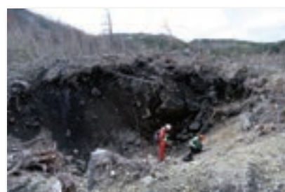
土壌ガス調査（本白根山2018年噴火の新火口） 地中からごく微量の火山ガスを採取し、マグマ活動や 流体流動経路を明らかにすることを目指しています。
