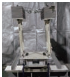
(b) 浮き なし 実験後の残留変形
