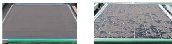
(a) “堆積厚>粒径” (垂水S, 堆積厚0.5mm) (b) “堆積厚<粒径” (新燃岳L, 堆積厚0.35mm)
