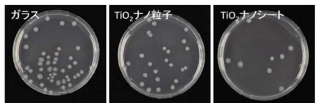
図2 寒天培養法による細菌コロニー形成の変化
